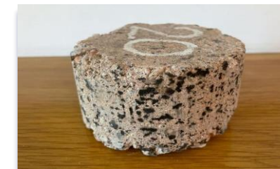
RAP + RCC ESPUMADO
